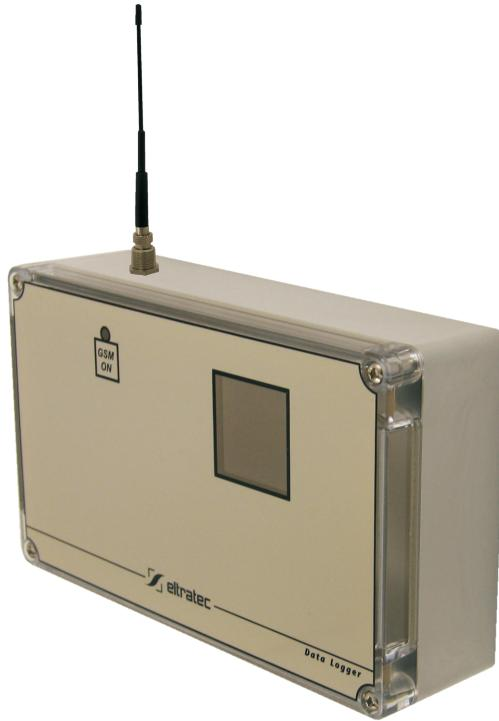
Registrator GSR 310 meri in registrira temperaturo, pretok ali druge tehnološke veličine, ki imajo standardni tokovni signal. Elektronika z GSM modemom je v ABS ohišju, konektorji so na steni ohišja, na katere priključimo vhodne senzorje.
